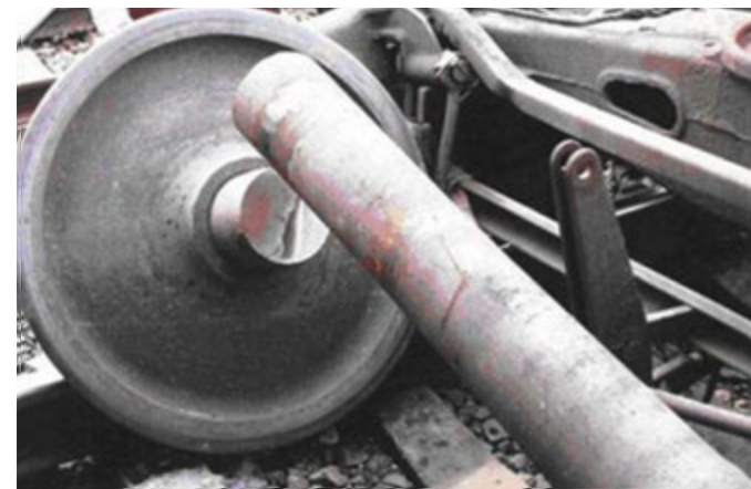
Рис. 1. Разрушение колёсной пары
