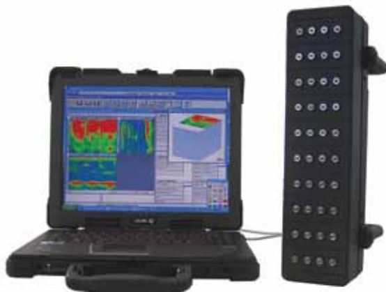
Томограф по бетону
