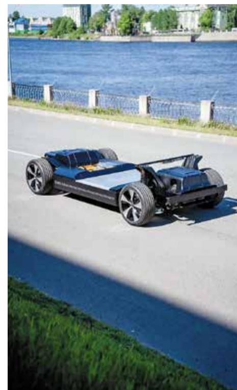
и предусматривает использование комбинированных силовых установок, например газоэлектрическую компоновку по схеме последовательного гибрида с электрогенератором на компримированном природном газе. Платформа создана для массового производства широкого модельного ряда автомобилей на новых источниках энергии. Грузоподъемность – до 700 кг полезной нагрузки в составе автомобиля, мощность батареи – до 90 кВт·ч, запас хода – до 950 км.
