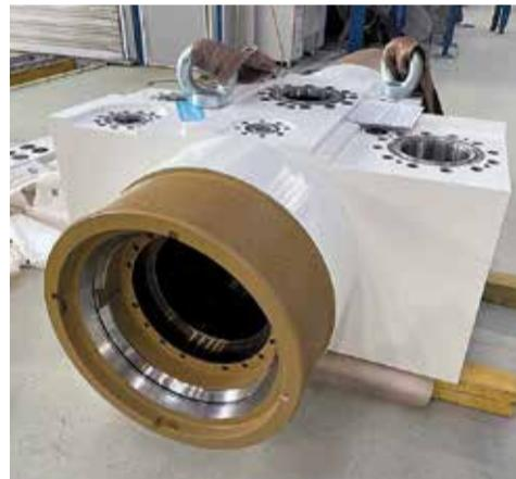
насосно-компрессорных труб, запорной арматуры эксплуатационной и сервисных линий, регулирующей арматуры подачи химреагентов и ингибитора коррозии, устьевого соединителя, боковых блоков. В данном изделии внедрен комплекс уникальных технологических решений по подготовке, контролю и нанесению антикоррозионной никельсодержащей наплавки на пересекаемых поверхностях, а также применена уникальная технология антикоррозионного лакокрасочного покрытия с наполнителем из политетрафторэтилена ксилен.
