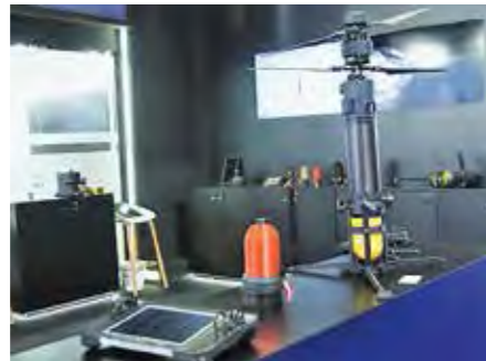
Рис. 8. Барражирующий боеприпас «Фолос», БЧ и планшет управления (справа налево)
