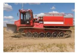
личные препятствия. Гидромеханическая коробка передач с гидрообъёмным механизмом поворота в сочетании с широкой гусеницей (600 мм) создают возможность эффективной работы на переувлажнённых грунтах и при высоте снежного покрова до 1,5 м.
