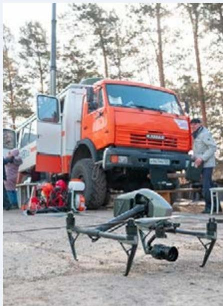
Холдинг «Росэлектроника» Госкорпорации «Ростех» создал мобильный комплекс для управления тушением лесных пожаров. Новая разработка на шасси КАМАЗ повышенной проходимости обеспечит пожарных устойчивой связью и оперативной информацией в труднодоступной местности, где отсутствуют традиционные каналы связи.
