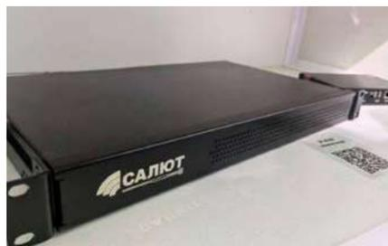
KVM (keyboard, video, mouse – клавиатура, видео, мышь) – коммутатор позволяет одновременно управлять несколькими устройствами, не подключенными к глобальной сети. В том числе – создавать и контролировать удаленные рабочие места, управлять сразу несколькими станками с ЧПУ, выполнять удаленное включение, выключение или перезагрузку оборудования, настройку первичного загрузчика и другого программного обеспечения, контролиро-
