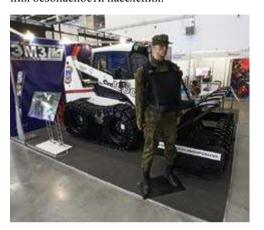
Машина разминирования разработана на базе мини-погрузчика Ant-1000 предприятиями «Высокоточных комплексов» - Ковровским электромеханическим заводом и ВНИИ «Сигнал». Назначение и особенности МГР4 «Шмель» работа по зачистке территорий от противопехотных мин (гуманитарное разминирование), проведение видеомониторинга окружающей обстановки с дальностью действия сигнала радиоуправления до 1000 м. Впервые робот-сапер был представлен в мае этого года на Международном салоне «Комплексная без-
