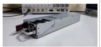
800 до 3000 Вт. Устройства обладают цифровым управлением, что повышает энергоэффективность во всем диапазоне нагрузок. В изделиях предусмотрена защита от превышения тока, короткого замыкания, перегрузок, повышения температуры, изменения напряжения в сети.
