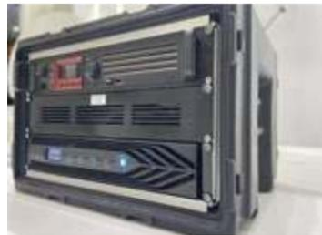
В состав переносной базовой станции, разработанной концерном «Созвездие», входит ретранслятор, шестиметровая телескопическая мачта с антенной, высокочастотные фильтры и источник питания со встроенными аккумуляторными батареями.
