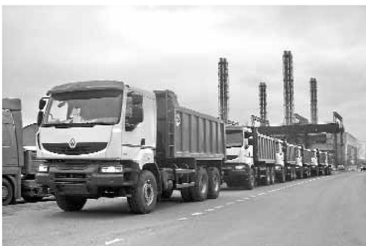
Грузовой автомобиль представленной для «РосДорСтроя» марки оснащен двигателем DX11 мощностью 380 л.с. Полная масса автомобиля — 34 т. При этом машины, поставленные для Санкт-петербургской компании, оснащены набором функций для работы в условиях сурового климата. В этот набор входит система для подогрева масла в двигателе, когда грузовик стоит на месте, а также охлаждающие жидкости, способные выдержать температуру
