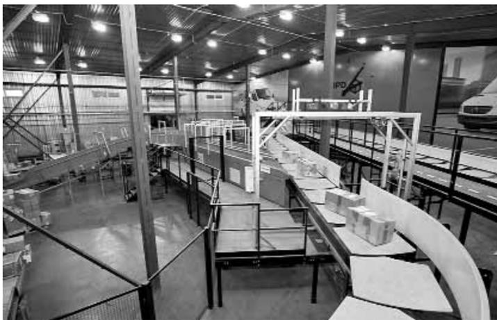
центральном терминале, может быть увеличено на 50%. Интеллектуальная система контроля сортировочного комплекса, которая управляется одним оператором с центрального пульта, позволяет обеспечить оптимальную загрузку мощностей терминала. Внедрение сортировочной системы также существенно сокращает ручной труд благодаря автоматизации операций сканирования, сортировки по направлениям, взвешивания и обмеривания посы-
