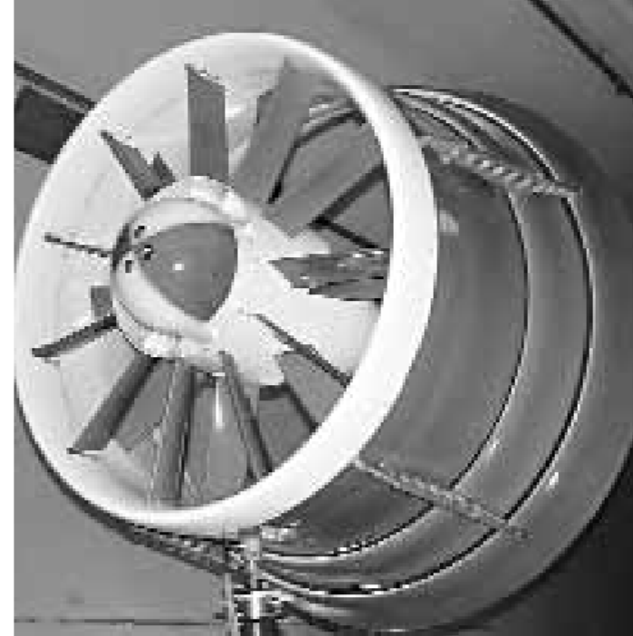
В процессе испытаний в аэродинамической трубе Т-2 ЦАГИ найдены оптимальные углы установки лопаток турбины и направляющего аппарата, обеспечивающие максимальную выработку электрической энергии встроенными в модели генераторами. Определена вырабатываемая электрическая мощность в широких диапазонах скоростей ветра, электрической нагрузки и углов поворота лопаток турбины. На специальном прецизионном оборудовании вентиляторной лаборатории Московского комплекса ЦАГИ отработана методика и проведены отдельные тарировочные испытания электрогенераторов.
