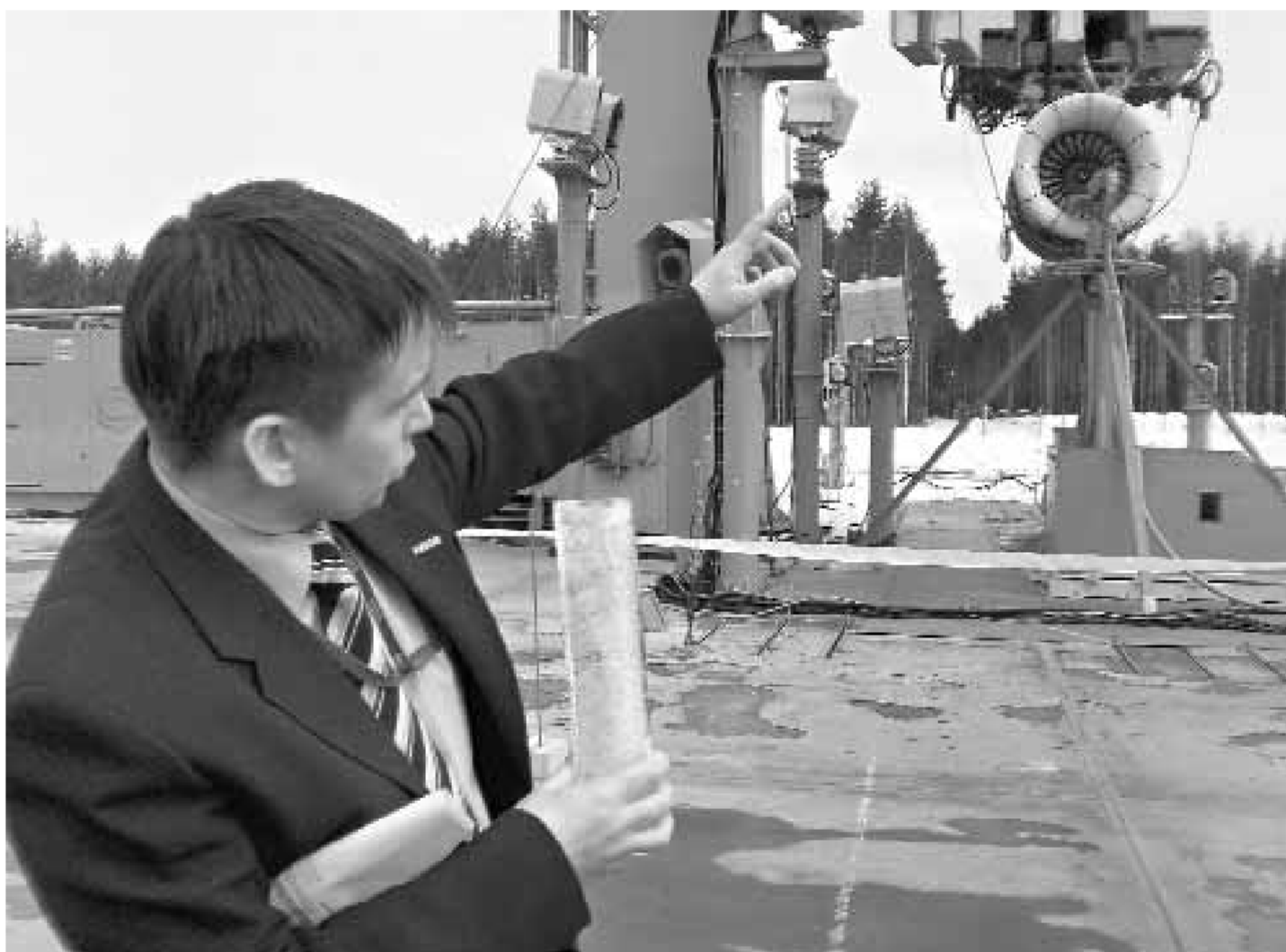
Именно такие пластины льда «забрасывают» в двигатель во время испытаний
