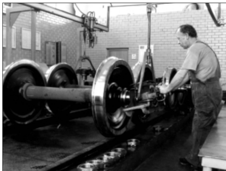
На снимках: главный корпус института; комплект для монтажа букс на оси колесных пар железнодорожных вагонов
